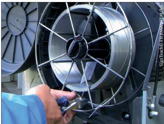
Einführen und Sichern einer Drahtelektrodenspule
